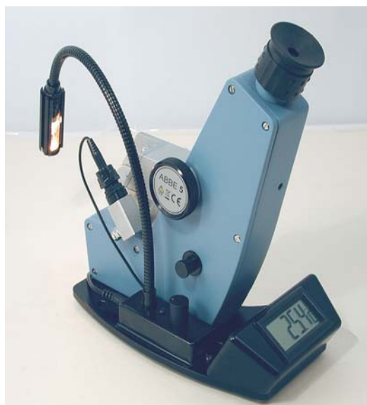
Figura III.3.5. Stânga: refractometru Abbé; dreapta: mersul razei de lumină într-un refractometru Abbé.
